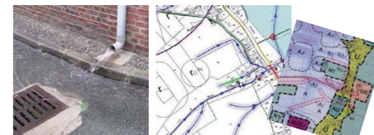
Le zonage pluvial réglemente les rejets sur la voirie et dans le réseau et peut être intégré dans le document d'urbanisme
